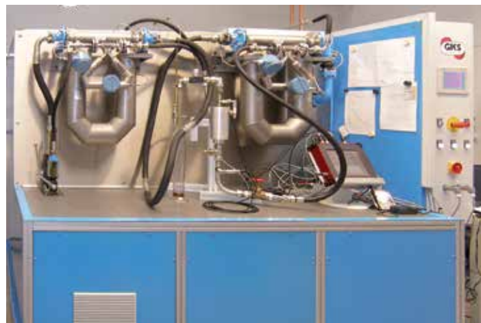
Banc d'essai de caractérisation de la désaération
