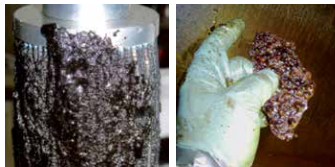
Détériorations dues aux décharges électrostatiques au niveau du fluide de service
